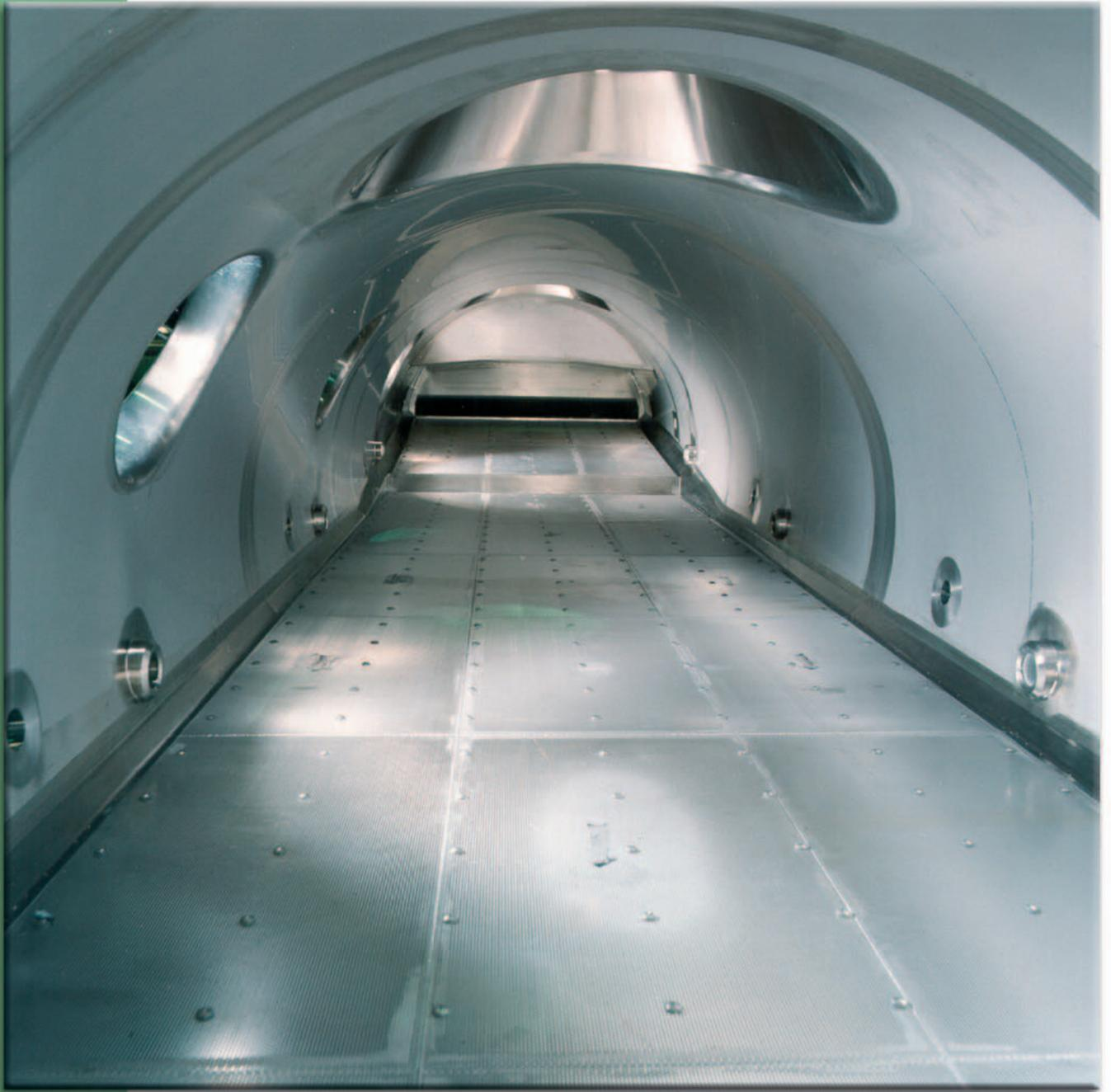
CONIDUR®-Feinlochblech als Anströmboden in einer Fließbettanlage.
